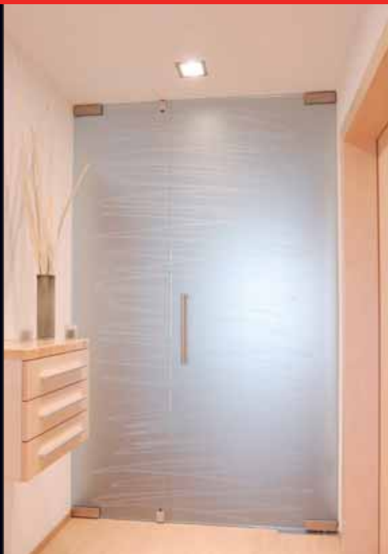
2-křídle dveře 900+568/2354 (1-křídle kyvné, 2-křídle fixní - západky), stavební otvor: 1468/2354, sklo: satínáto bílé 10 mm, dekor: S M40 P kování: zavírač BTS 75 V + Universal PT (nerez brus) + madlo atyp (nerez brus)
