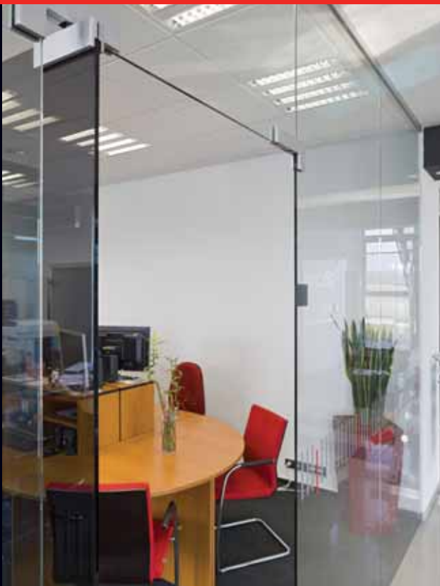
1-křídle kyvné dveře 1000/2200 s 3 x bočním světlíkem a nadsvětlíkem, stavební otvor 4000/2940, sklo: dveře - planibel šedý 10 mm, boční světlík a nadsvětlík - float čirý 10 mm, kování: zavírač BTS 75 V + Universal PT (matná stříbrná) + madlo atyp (nerez brus), (fixní část kotvena dole do U-profilu a nahoře do Wandanschlussprofilu)
