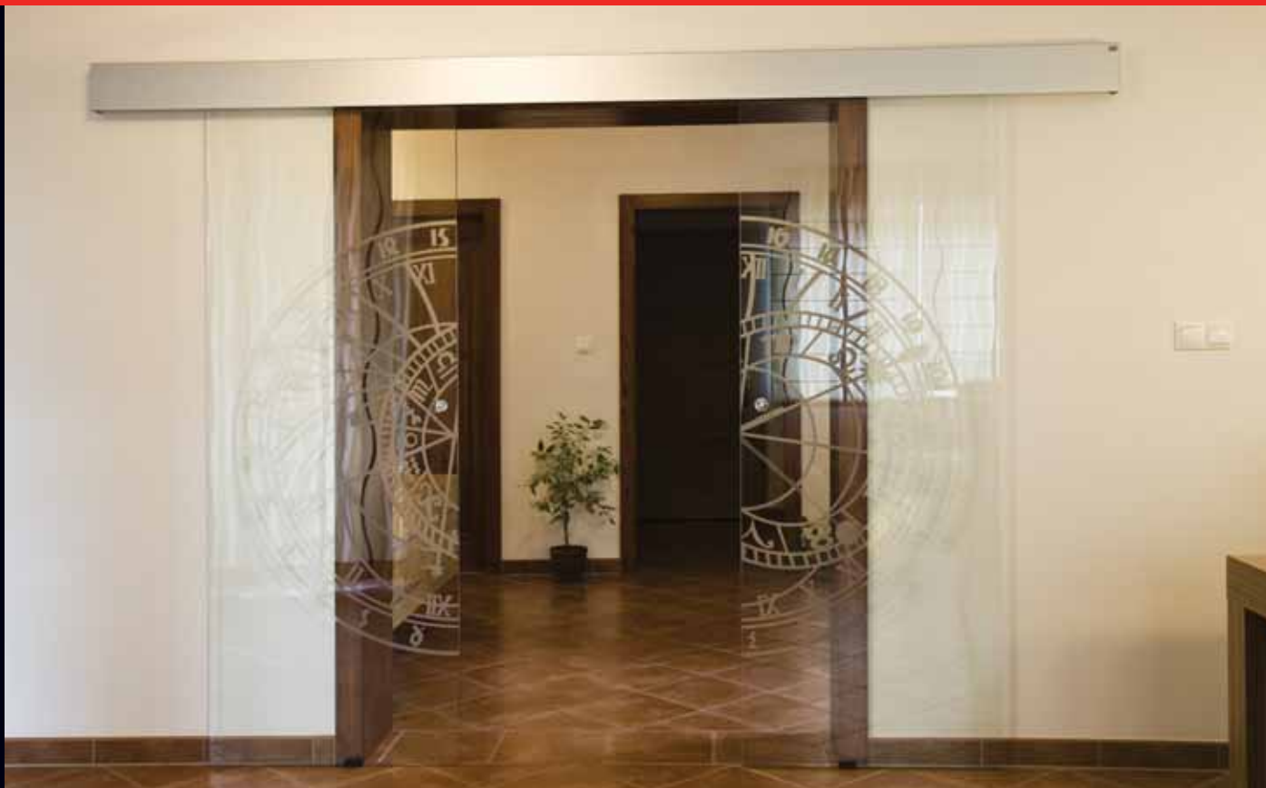
2-křídle posuvné dveře na stěnu (symetricky dělena), stavební otvor: 1510/2022, sklo: float čirý 10 mm, pískování atyp „ORLOJ“, kování: Dorma RS 120 synchro (matná stříbrná) + KN 02 (sklo)
