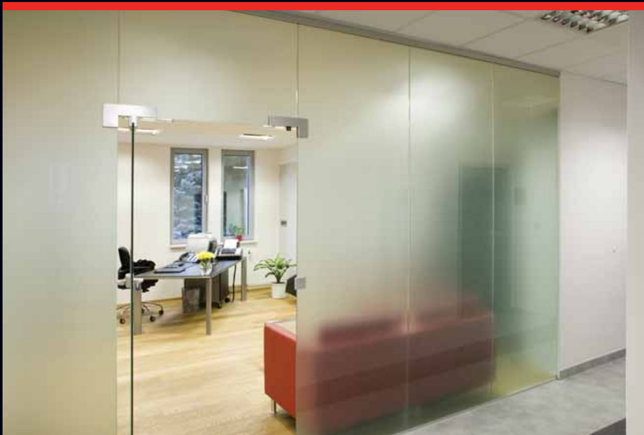
1-křídle otočné dveře 970/1970 s 4x bočním světlíkem a nadsvětlíkem, stavební otvor: 4250/2620 (dveře uvnitř stěny), sklo: satínato bílé 10 mm, kování: čep do podlahy + Arcos Universal PT + klika AR 03/114 s protikusem (matná stříbrná)
