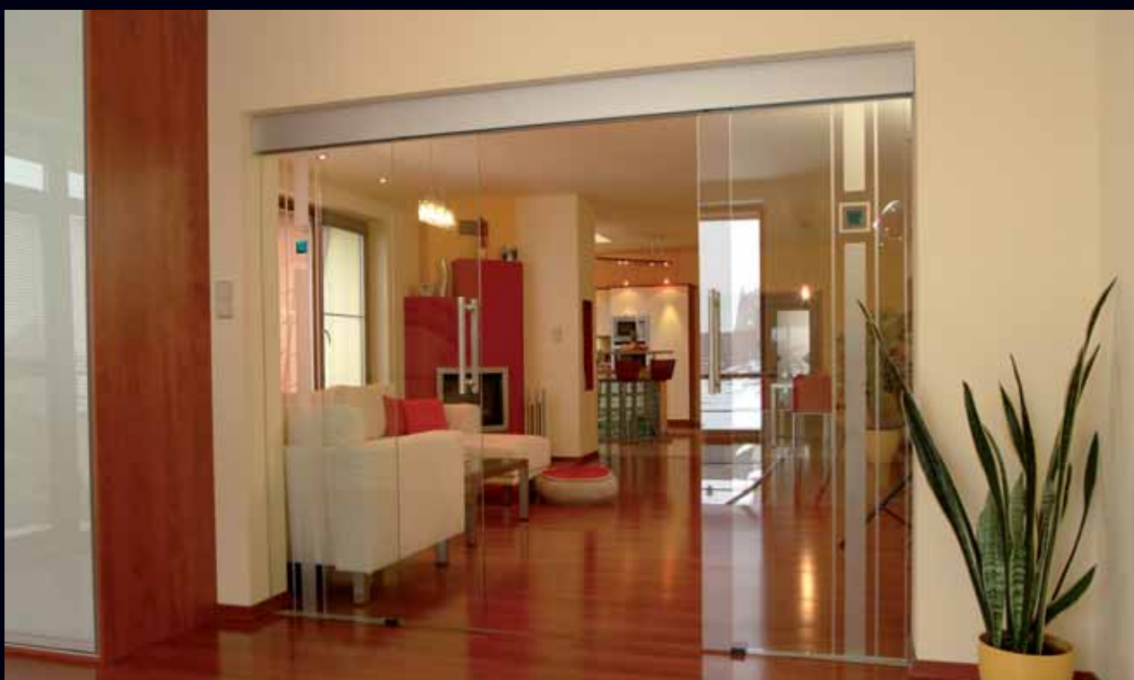
2-křídle posuvné dveře na boční světlík (symetricky děleno), stavební otvor: 2400/2050, sklo: float čirý 10 mm, dekor: S KPM60 atyp kování: Dorma RS 120 (matná stříbrná) + MD 01 (nerez brus/lesk)
