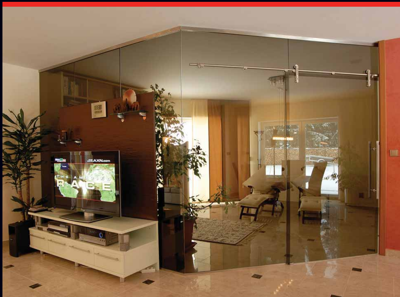
1-křídle posuvné dveře 1200/2200 s nadsvětlikem na boční světlík + fixní stěna, stavební otvor: 2920/2670 + 2400/2670, sklo: planibel bronz 10 mm kování: Manet 5.1 (nerez brus) + madlo MD 01 atyp (nerez brus/lesk)
