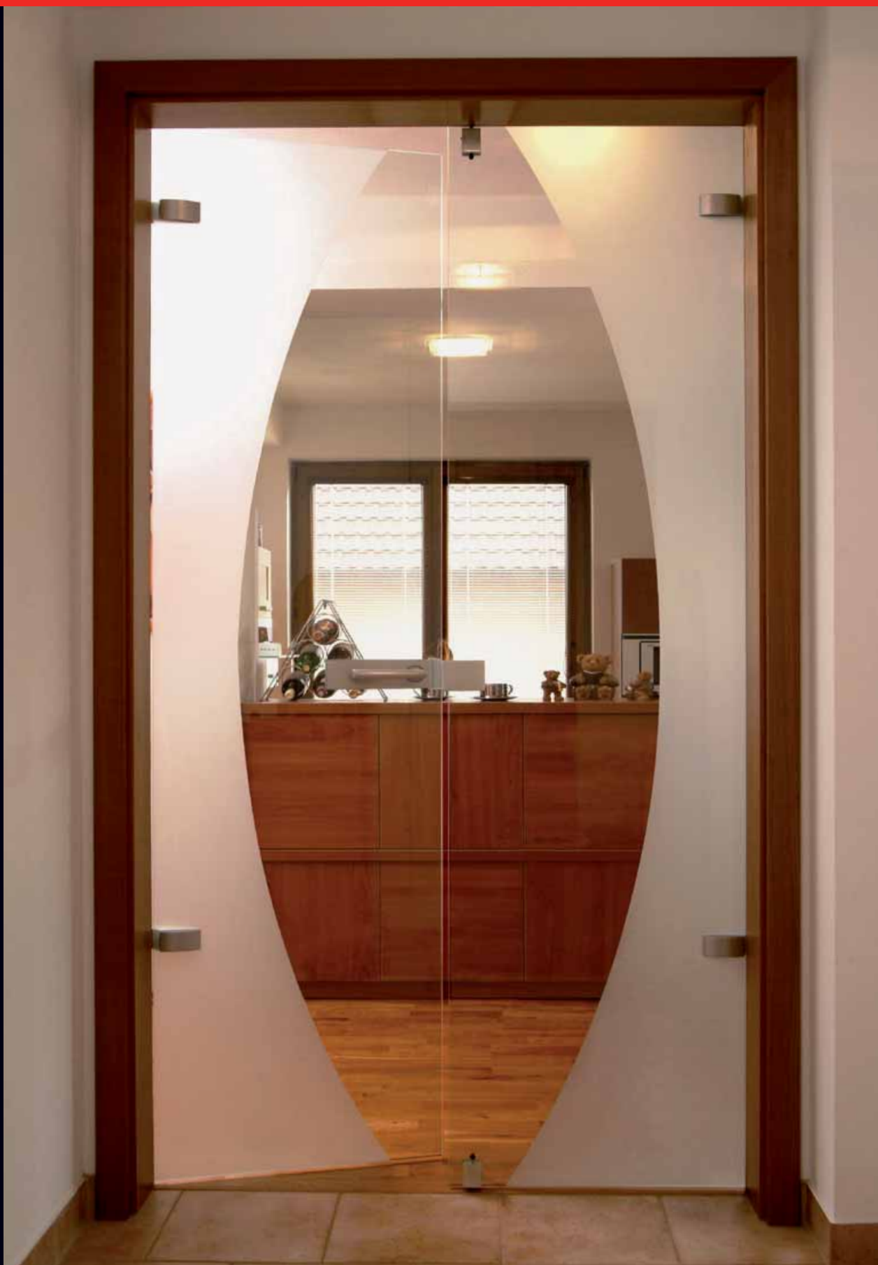
2-křídle otočné dveře 1400/1970 mm (dělení 700+700 mm) do obložkové zárubně, sklo: float čirý 8 mm, dekor: S M12, kování: Arcos 01/114 + protikus + západky
