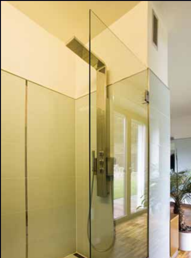
fixní sprchová zástěna 800/2050, sklo: float čirý 8 mm s povrchovou úpravou proti usazování vodního kamene, kování: BF 132 – úchyt "L" (chrom lesk)
