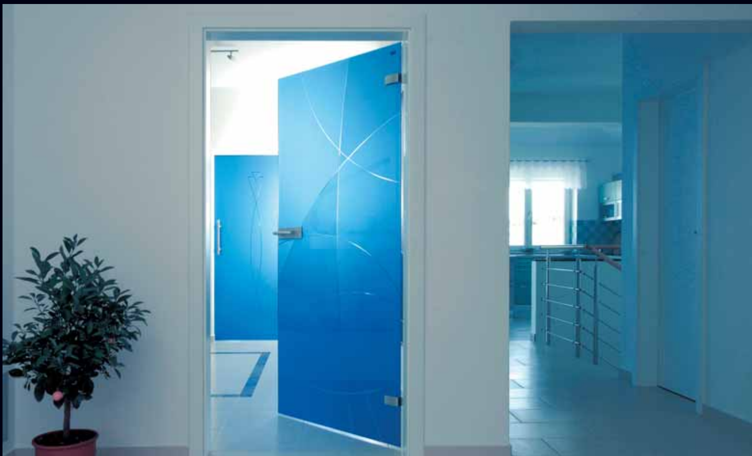
1-křídle otočné dveře 900/1970 mm do obložkové zárubně, sklo: satináto modré 8 mm, dekor: S GPM 29, kování: Arcos 01/114
