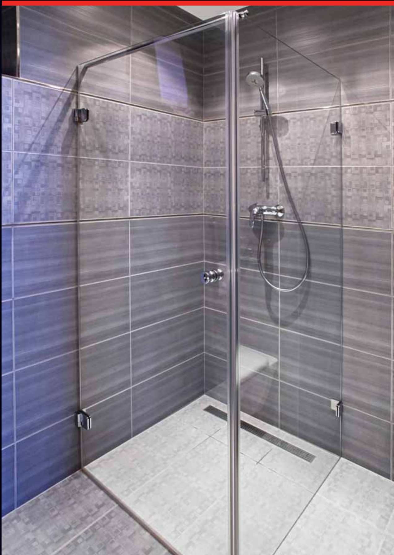
sprchový kout - 1 křídle otočné dveře 900/2000 s bočním světlíkem, stavební otvor: 900 x 900/2000, sklo: float čirý 8 mm s povrchovou úpravou proti usazování vodního kamene a zasychání kapek, kování: Dorma-GRAL BH 200 typ 130 (povrch lesklý chrom)
