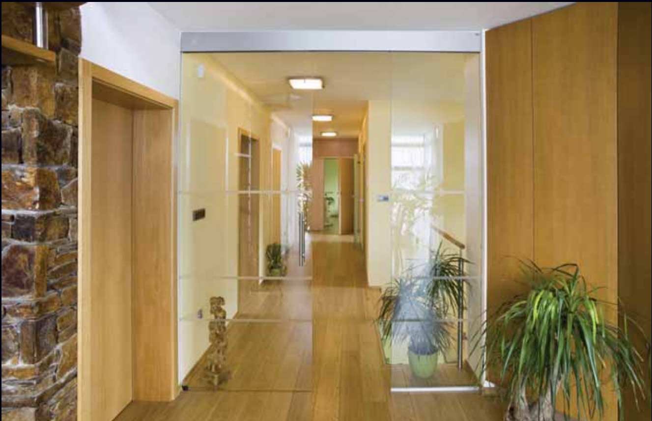
1-křídle posuvné dveře od bočního světlíku do zděného pouzdra, křídlo 1450x2510, stavební otvor: 2070x2510, sklo: float čirý 10 mm, pískované proužky kování: RS 120 (matná stříbrná) + madlo MD 01 (nerez brus/lesk)
