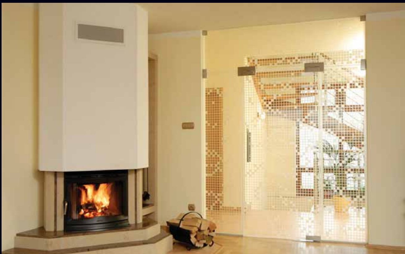
1-křídle kyvné dveře 900/2000 s 2x bočním světlikem a nadsvětlikem přes celou šířku, stavební otvor: 1800/2500 (dveře uvnitř stěny), sklo: float čirý 10 mm dekor: S M25, kování: zavírač BTS 75 V + Universal PT + zámek US 10 (matná stříbrná) + madlo MD 01 (nerez brus/lesk)
